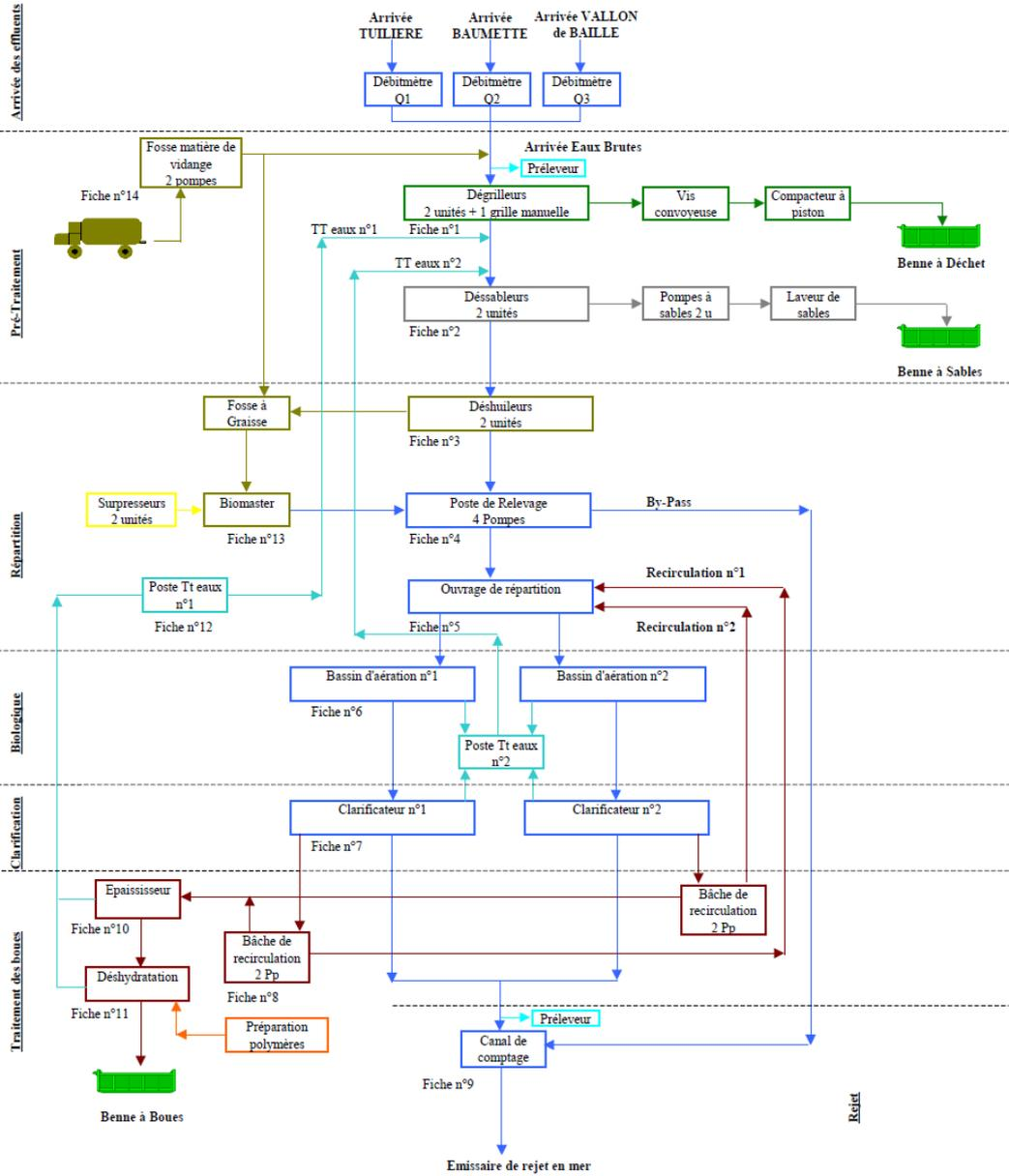
**Schéma de fonctionnement de la station d'épuration**
